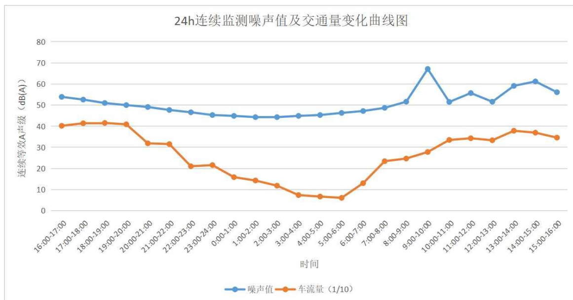
图 7.3-1 24h 连续监测噪声值及交通量变化曲线图
