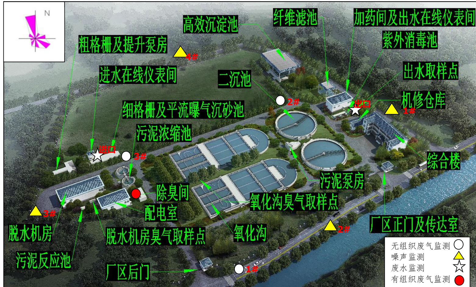
附图 2 项目平面布局图及监测布点图
